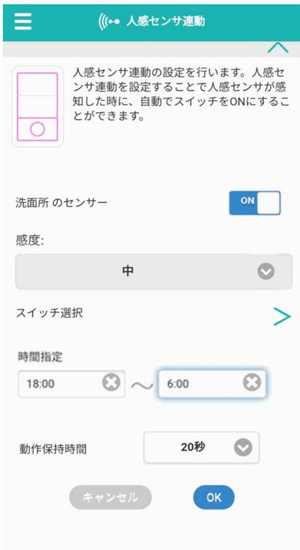
人感センサ連動がはたらく時間を18時～翌朝6時として、動作保持時間を20秒に設定した例です。
