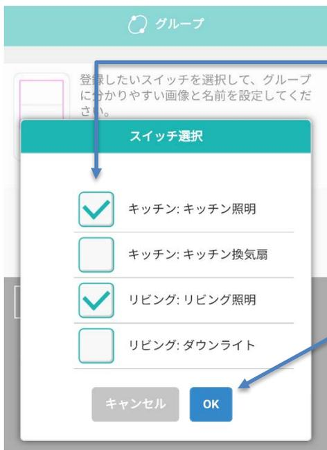
グループに組み込みスイッチをタップして選択します。グループに組み込まれたスイッチには「」が表示されます。
